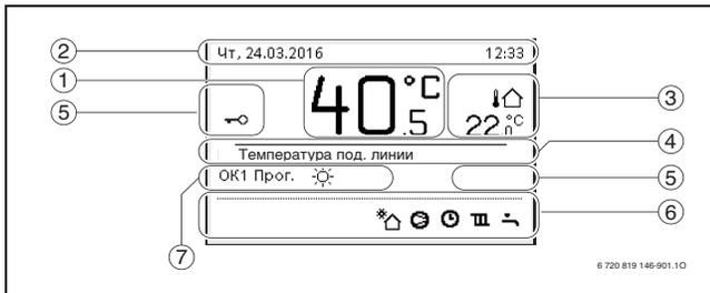
Рис. 6 Символы в стандартной индикации (пример дисплея)
